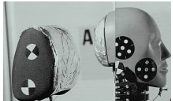
An «Crashtest-Dummys» werden die Schäden bei Auffahrkollisionen simuliert und analysiert.
